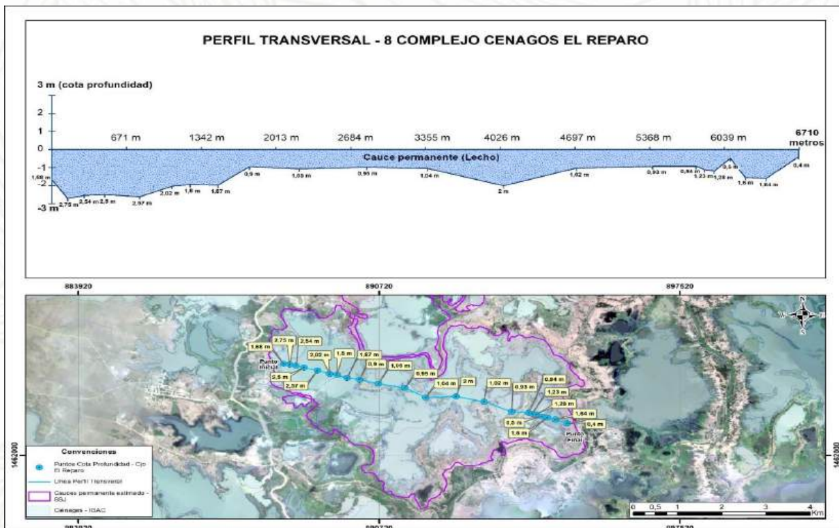
Ilustración 25. Perfil Transversal 8 – Ciénaga El Reparó
